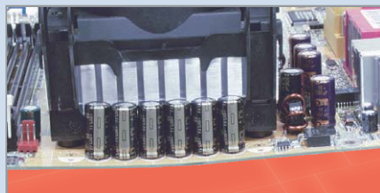
▲ Установка кулера приводит к сильному прогибу платы
