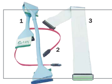
▲ Различия между кабелями заметны невооруженным глазом. Кабели: 1 — крученный Ultra ATA/100, 2 — Serial ATA, 3 — обычный Ultra ATA/100
